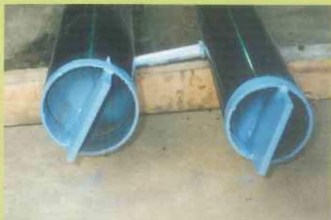
※材質：JIS G3444 一般構造用炭素鋼鋼管STK400
