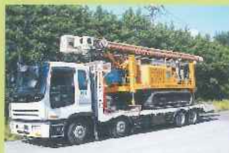
大型施工機 PD200RV2 低床回送車 での搬送
