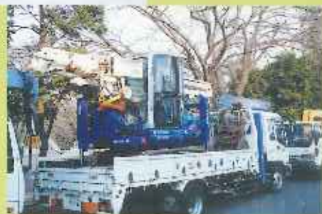
大型施工機 PD200RV2 低床回送車 での搬送
