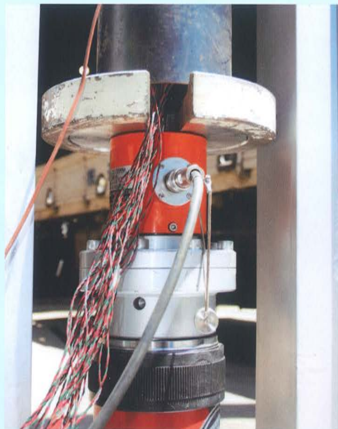
杭体剛性試験
